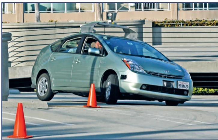
Pruebas con un vehículo modificado para funcionar autoconducido
