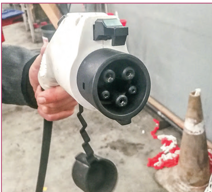
Enchufe para carga de vehículo eléctrico | Fabiola Zafra
