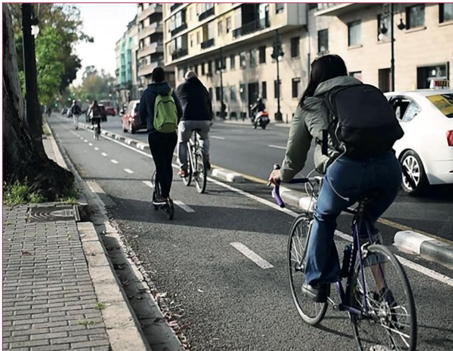
El trazado se dispondrá mayoritariamente en calzada y será bidireccional, con un ancho próximo a los 2,50 metros.
